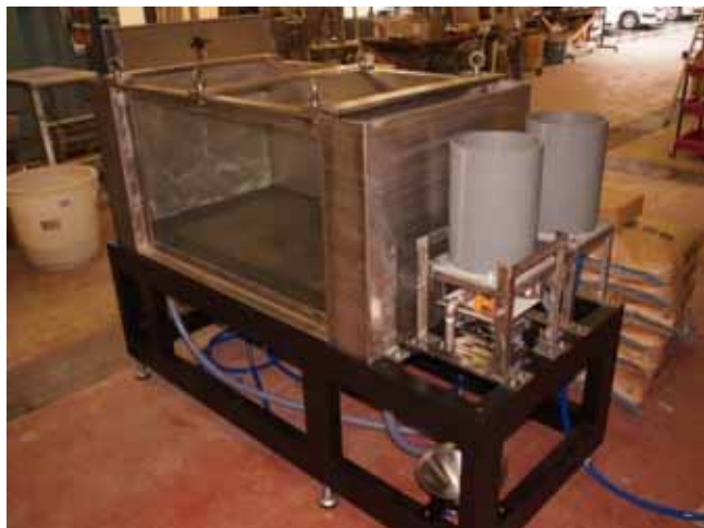
写真 3-1 浸透模型水槽
