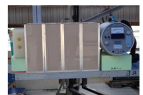
図3 放射線遮蔽実験の様子 (全中性子)
