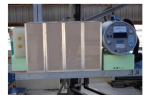
図3 放射線遮蔽実験の様子 (全中性子)
