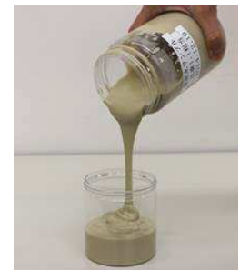
図2 超重泥水の様子
