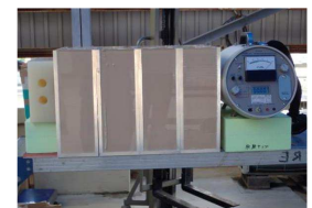
図3 放射線遮蔽実験の様子（全中性子）
