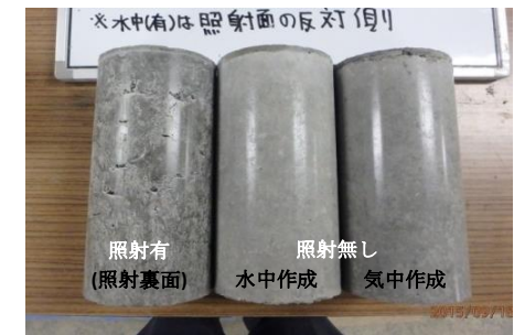
写真 フレッシュコン圧縮試験体の表面
