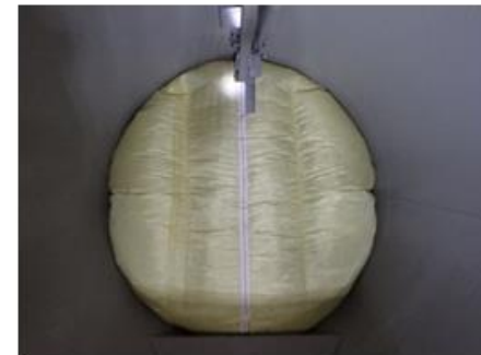
写真2 空気注入による閉止補助材の展開
