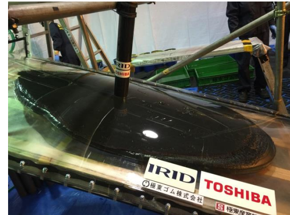
図10 実スケール試験体でのゴム材充填状況
