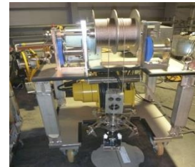
図12 ベント管視認用カメラ
