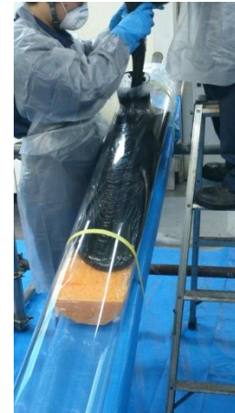
図9 1/10スケール試験体でのゴム材充填状況
