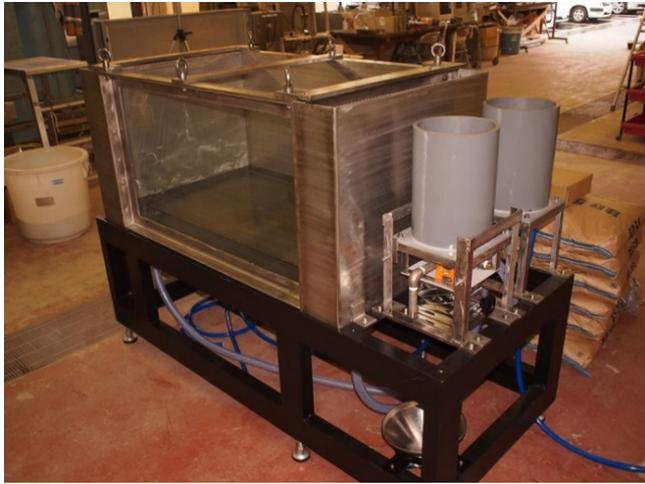
写真 3-1 浸透模型水槽
