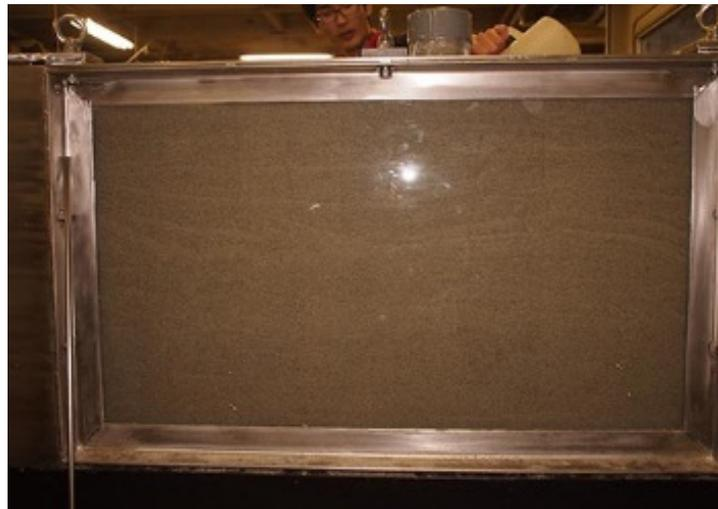
写真 3-2 浸透模型水槽の土層
