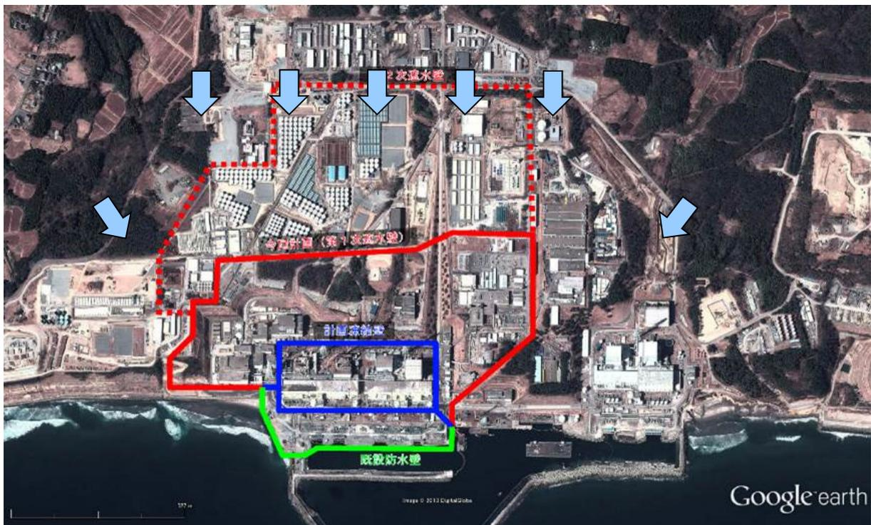
図 3-24 福島第一原子力発電所周辺の地下水流動
