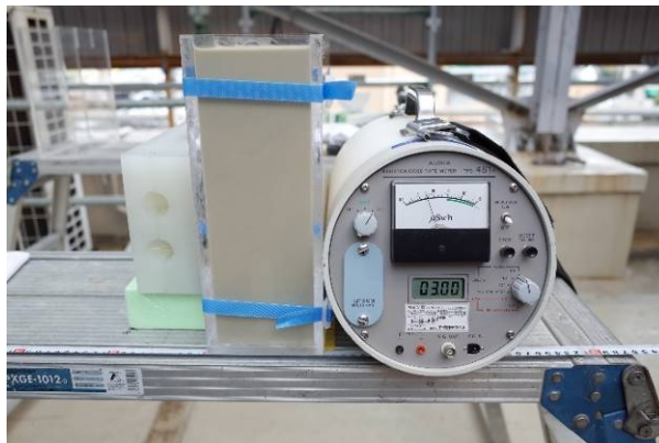
図 3-7 放射線遮蔽実験の様子（上：ガンマ線の遮蔽実験、下：中性子線の遮蔽実験）
