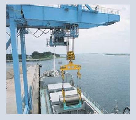
原燃輸送所有 (むつ小川原港) 150トン橋形クレーン ・非常時の対策 バックアップ電源 緊急停止後の 荷降ろし
