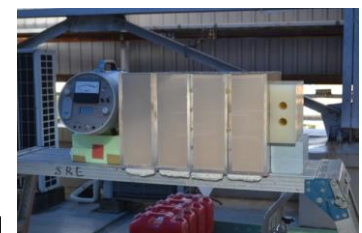
図5 超重泥水の全中性子線透過線量測定の様子
