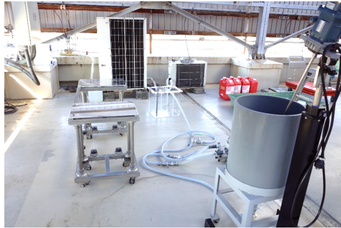
図 3.2-2 超重泥水の充填性実験装置の全体写真
