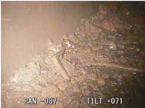
写真-1 燃料デブリと推定されている物質の現状例(東京電力ホールディングス:福島第一原子力発電所2号機 原子炉格納容器内部調査 ~19日調査速報~, 掲載日2018年1月19日 入手先< http://photo.tepco.co.jp/date/2018/201801-j/180119-01j.html >(参照2018.8.15))
