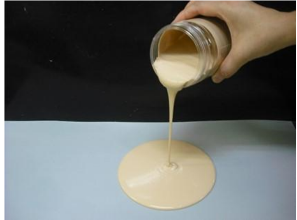
写真-2 高い流動性と放射能遮蔽性能をともに備えた超重泥水
