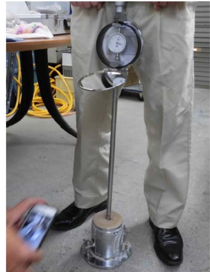
コーン貫入試験中
