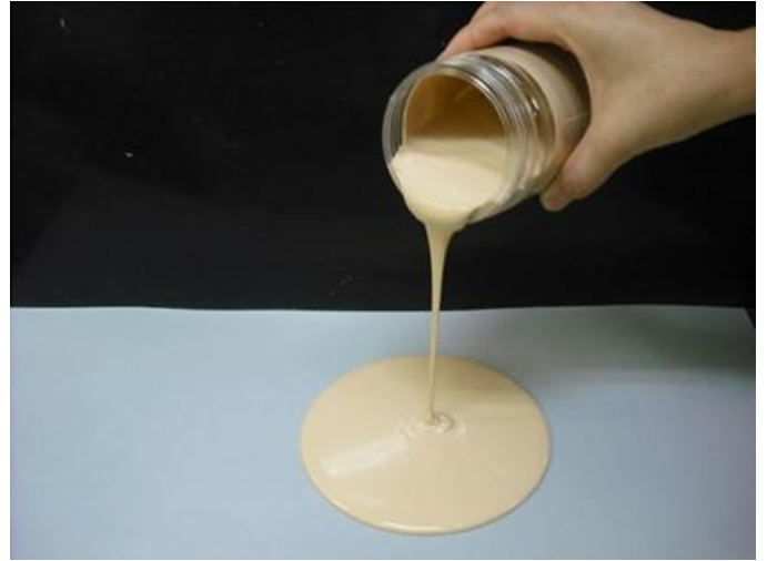
図－２ 高い流動性と放射能遮蔽性能をともに備えた超重泥水
