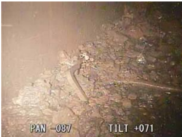
図－1 燃料デブリと推定されている物質の現状例（東京電力ホールディングス：福島第一原子力発電所2号機 原子炉格納容器内部調査 ～19日調査速報～，掲載日2018年1月19日 入手先< http://photo.tepco.co.jp/date/2018/201801-j/180119-01j.html >（参照2018.8.15））
