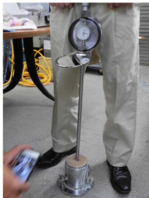
コーン貫入試験中
