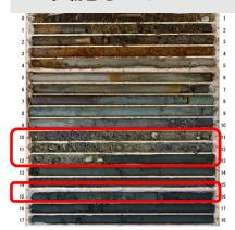
深度0~2.75m 盛土 深度2.75~7.40m 有機質粘土 深度7.40~9.20m 凝灰質粘土 深度9.20~10.30m 砂質シルト **深度10.30~12.40m 砂礫**
